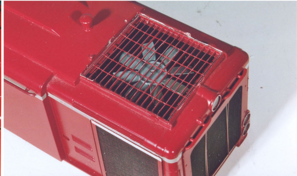
Soeben wurde der Lüfterkasten eingesetzt, es sind noch einige Pinselstriche erforderlich, um die Lackschäden durch Ausfeilen der Öffnung zu beheben
