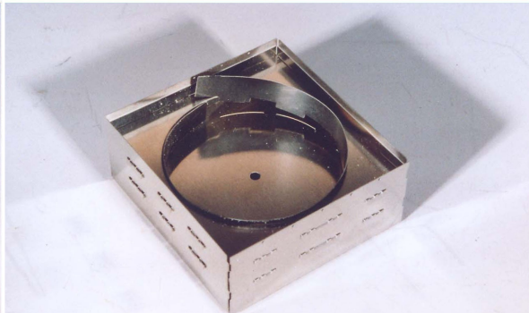
Die Einfassung wird vorgebogen, daß der Durchmesser im vorgebogenen Zustand größer ist als im eingesetzten Zustand - ein paar Lötunkte reichen aus.
