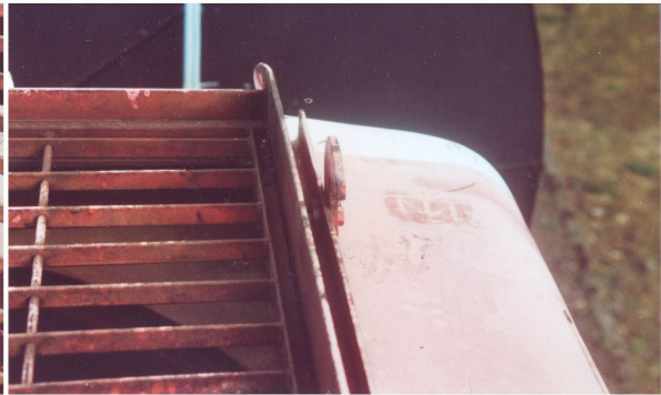
Abbildung zeigt den Begrenzungshaken (rechts) und die Tiefe der Gitterkonstruktion
