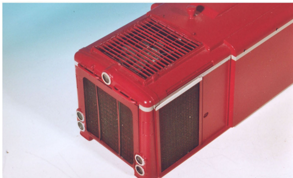
Wenig Arbeit, aber große Veränderung: Lokgehäuse mit neuen Kühlergittern, Lampenringen, und dem eingebauten Lüfter sowie feinen Anhebesen
