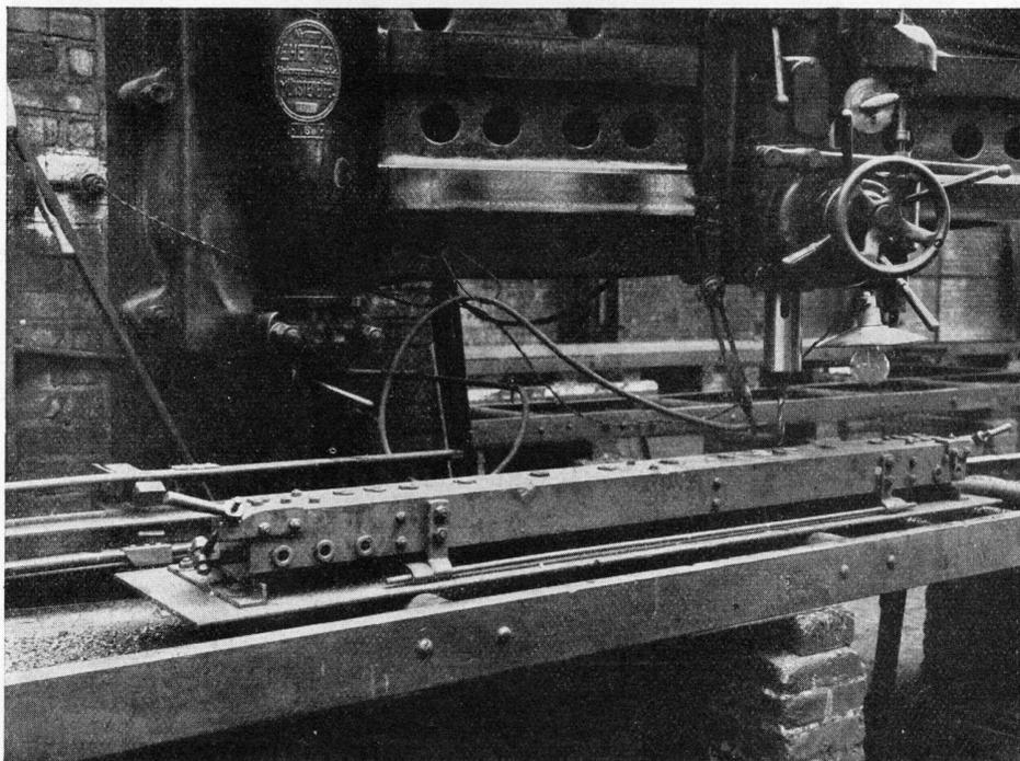
Bohren eines Werkstückes in doppelseitiger Schablone
